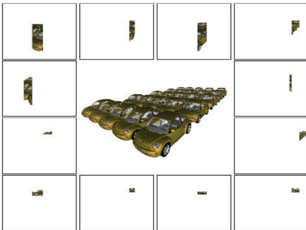
图 23.18。sort-first 会将屏幕划分成多个 tile，并为每个 tile 分配一个处理器。然后将图元发送给与它们相重叠的处理器。这与 sort-middle 架构不同，后者需要在几何处理完成之后，再对所有的三角形进行排序。只有在所有三角形都被排序之后，才能开始逐像素的光栅化。
