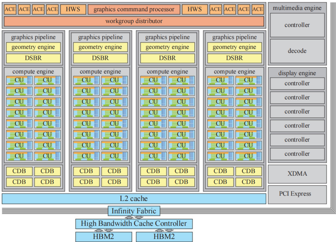
图 23.29：使用 64 个 CU 构建的 Vega 10 GPU。请注意，其中的每个 CU 都包含了如图 23.28 中所展示的硬件单元。[35]
